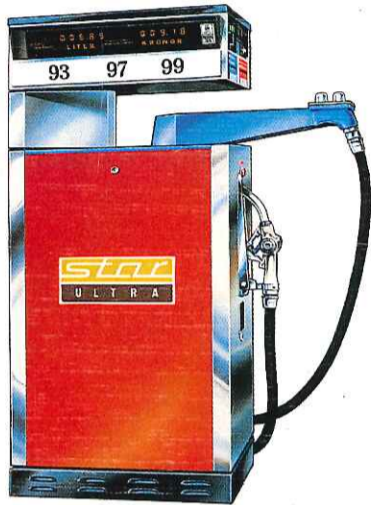
STAR ULTRA U20, 1972. Detta är Ljungmans första elektroniska pump. Troligen den första i världen. Den styrs av en elektronikcentral inne i bensinstationen. Finesserna var många bl a förinställning av belopp och knappar för oktanval.
