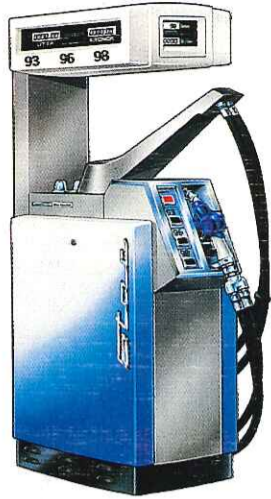
STAR ULTRA 850, 1983. Här har den datorstyrda elektroniken tagit över helt. Oktanblandningen är elektroniskt styrd. Pistolventilskontakten har inga rörliga delar. Siffrorna är av typ flytande kristaller.
