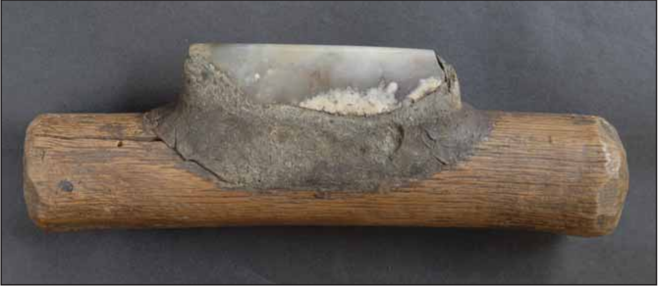
Resim 85- Kağıt aherlemede kullanılan çakmak taşı mühre. (Emin Barın koleksiyonu)
